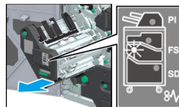
**3** Поверните ручку [FS8] и вытяните вертикальную выравнивающую планку укладчика.
