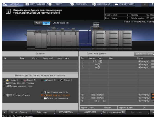
Добавьте kleевые гранулы в **устройство kleевого скрепления PB-503**.
